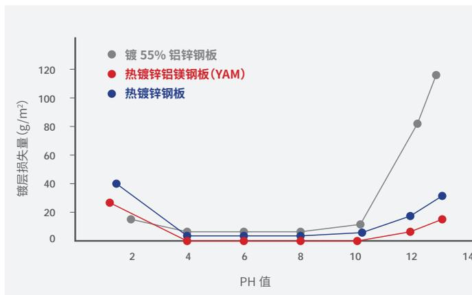
新宇镀锌铝镁板是新一代革命性中铝镀层产品,简称YAM。其合金镀层是采用锌、铝以及添加镁元素高温固化形成,其结构由锌、铝和MgZn<sub>2</sub>的致密三元共晶组织构成,从而使钢板表面形成一层致密的、有效防止腐蚀因子穿透的屏障,有着优异的耐化学品性能、耐红锈性能、剪切端面的自愈合防腐性能及焊接性能,大大延长了建筑物使用寿命。
